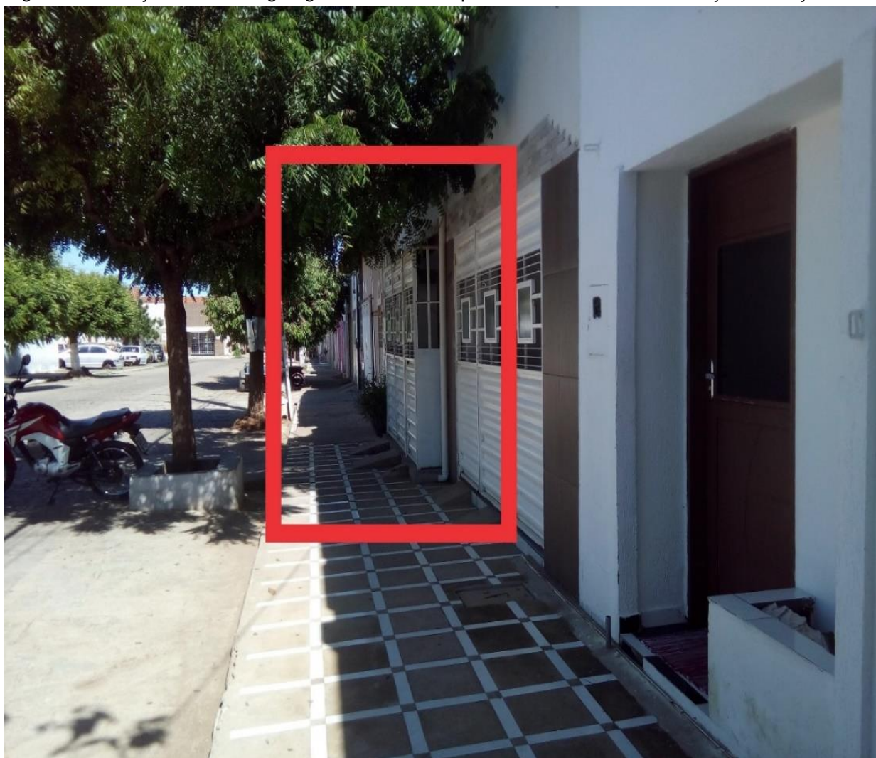
Figura 14. Avanço indevido da garagem de uma casa particular diminuindo a circulação da calçada
